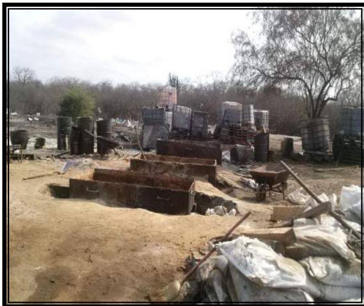
Foto 11. Cocina en tanques rectangulares de hierro naval con leña.
